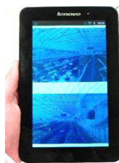
温度を色に変換し画像と合成
