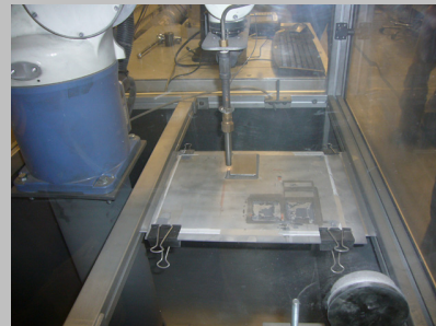
コールドスプレー法によるコーティング
