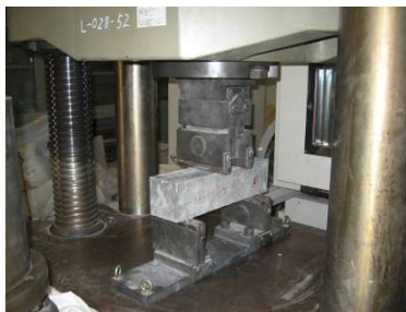
図2 硬化コンクリート試験 (曲げ試験)
