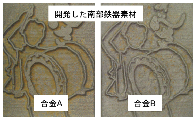
図4 腐食試験後の試験片 腐食条件：水中に5分間漬けた後乾燥
