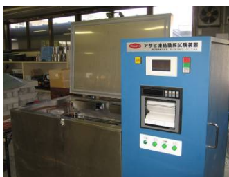
図2 凍結融解試験装置
