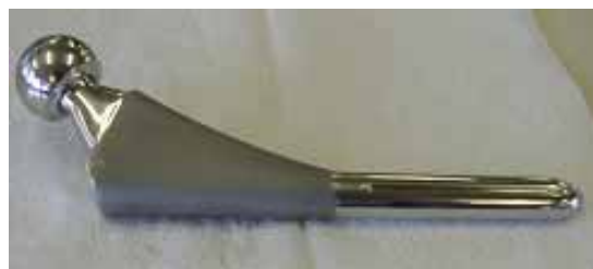
図2 CoCrMo合金人工股関節の試作品
