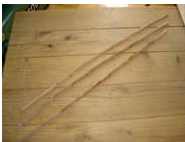
図1 圧縮処理・切削後木片
