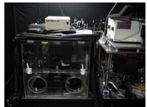
図.3 顕微ラマン分光システムの概観
