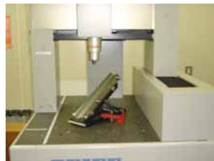
図2 三次元測定機の性能評価
