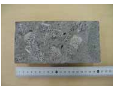
供試体の破断面
