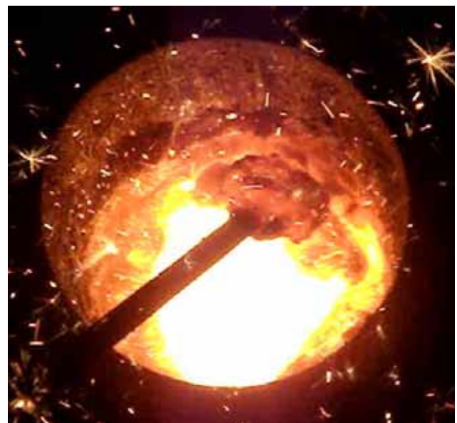
図2 酸化鉄とアルミナ0.8%添加したときの 鑄鉄溶湯表面の様子 (除滓が良好)
