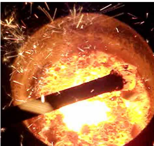
図1 酸化鉄と酸化珪素0.8%添加したときの 鑄鉄溶湯表面の様子
