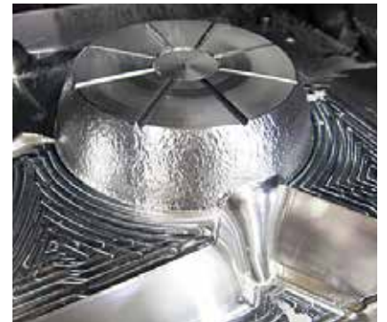
NC加工したマッチプレート
