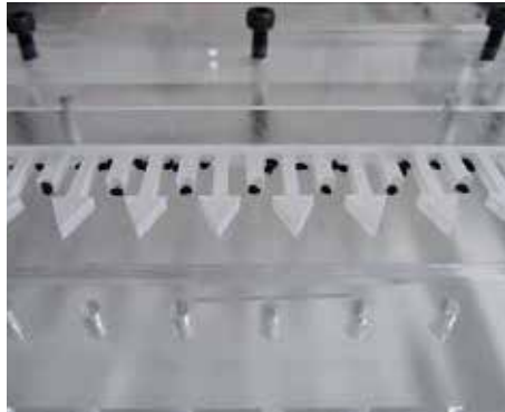
裸種子の一粒供給の様子 (裸種子を先端部の窪みに一粒保持)
