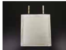
小型ラミネート型セルの試作
