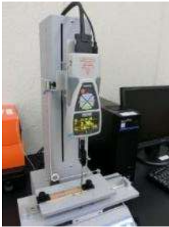
めっき密着性評価 90° 剥離試験 (JIS K 6854準拠)
