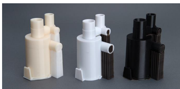
機械部品（左：ABS製、中：PC製、右：Nylon 12製）
