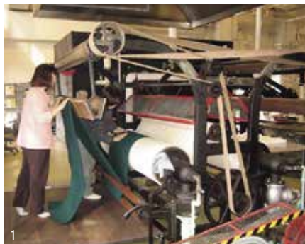
昭和26年に設備が完備され、ホームスパンは驚異的発達を遂げたホームスパン仕上加工設備 1. 蒸絨機 2. 巾出乾燥機 3. 縮絨機
