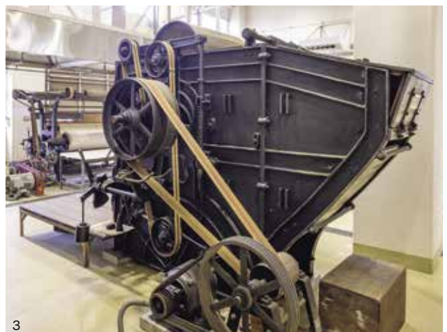
昭和26年に設備が完備され、ホームスパンは驚異的発達を遂げたホームスパン仕上加工設備 1. 蒸絨機 2. 巾出乾燥機 3. 縮絨機
