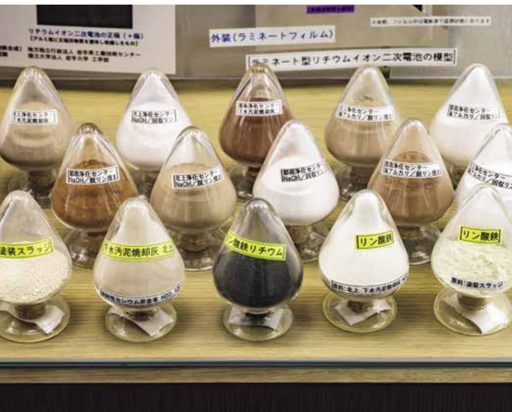
下水汚泥焼却灰と回収されたリン酸鉄
