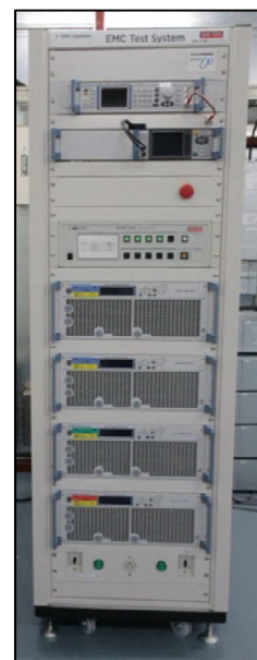
パワーアンプ等一式
