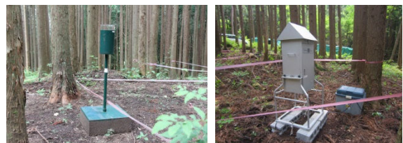
写真 ダストジャー（左）とハイボリュームエアサンプラー
