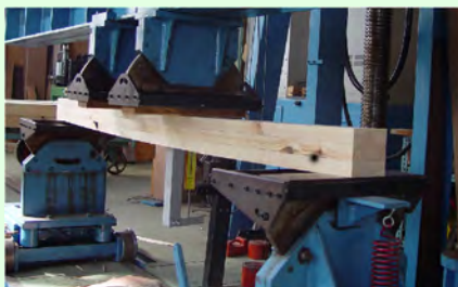
写真 曲げ試験の様子
