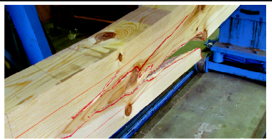
写真1 アカマツ平角材の節を起因とする目切れ破壊
