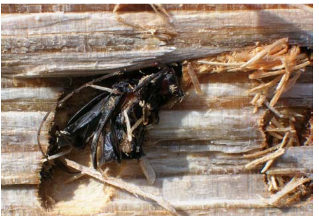
写真-3 熱処理しない対照材内のマツノマダラカミキリ成虫
