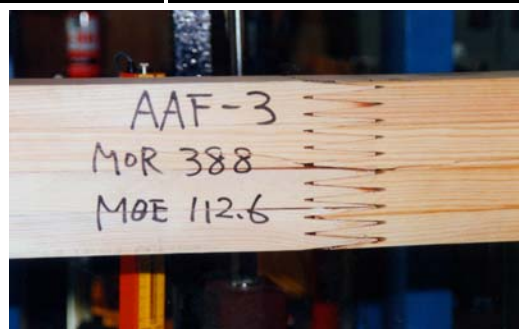
ラージフィンガージョイント部の曲げ破壊の状況
