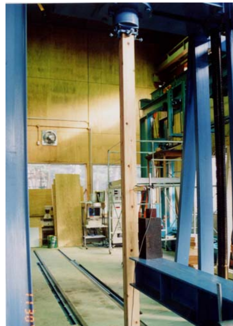
異樹種集成材の長柱座屈試験の状況
