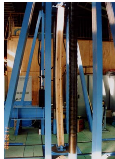
スギの長柱座屈試験の状況
