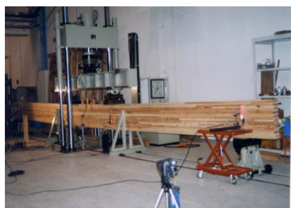
大断面集成材の曲げ強度試験
