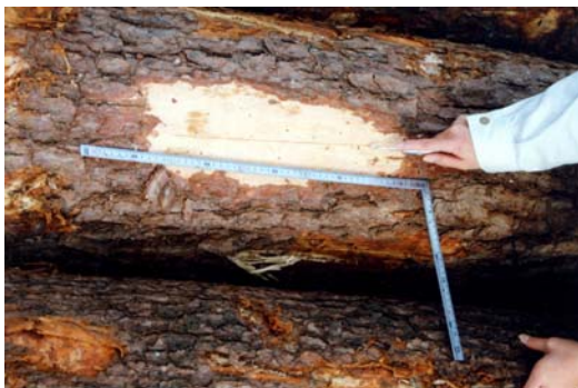
写真1 丸太の繊維傾斜の測定
