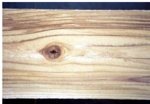
被害後6ヶ月経過材の乾燥状態での変色
