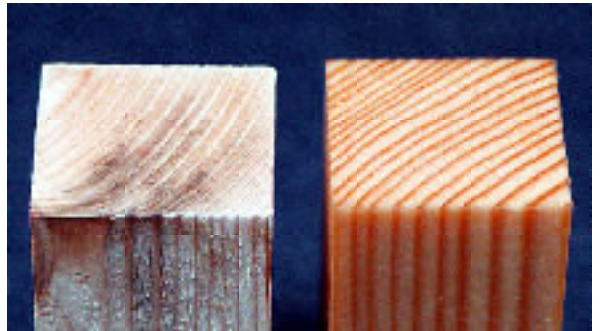
写真2 水浸漬試験30日後の試料 (左: 無処理スギ辺材 右: パラフィン処理スギ辺材)
