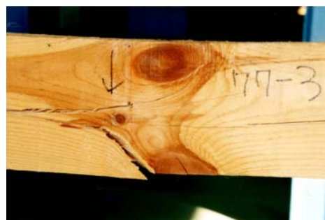
枝打ち無処理材の曲げ破壊の様子 (節付近からの破壊)
