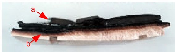
無処理材 a : 表層が焼失している b : 内部まで炭化が進行している
