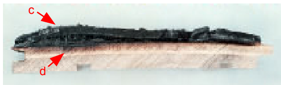
処理材 c : 表面に被膜を形成している d : 表層で炭化が止まっている
