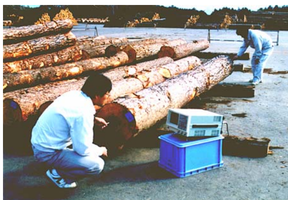
打撃による動的ヤング係数の測定
