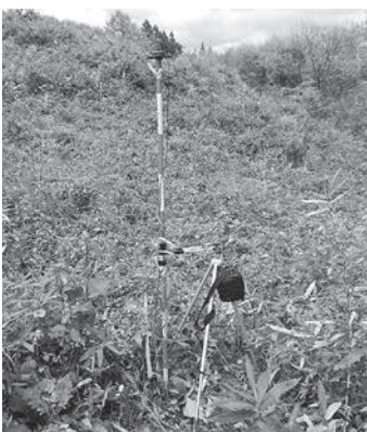
写真1 GNSS計測状況
