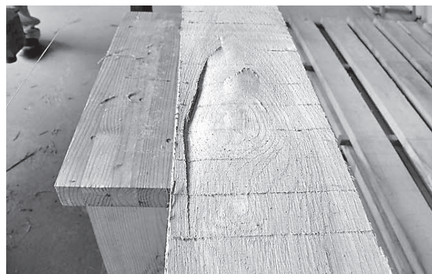
写真1 落込みによる割れ (コナラ)
