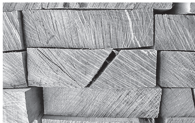
写真2 木口面の貫通割れ (コナラ)
