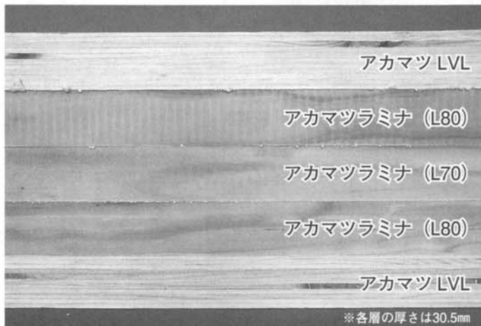
写真1 LVLを最外層に利用した新構造用材料の構成
