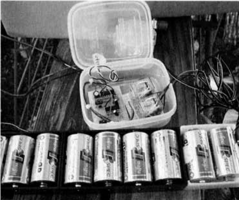
写真-2 制御回路と単一電池
