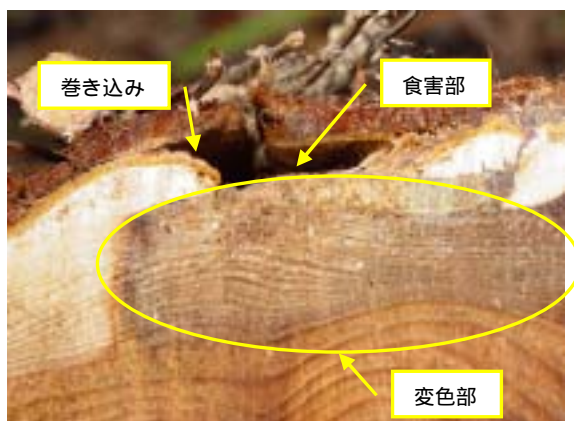
写真-1 スギカミキリ被害丸太の木口面
