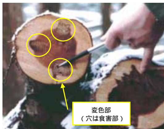
写真-2 スギノアカネトラカミキリ被害丸太の木口面
