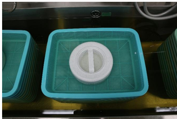
写真2 新たに加えた中性洗剤による洗浄工程
