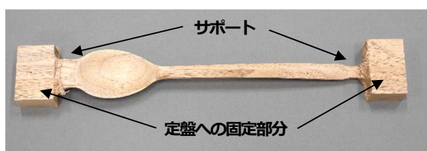
図 2 サポートを付与したスプーンの CNC 加工
