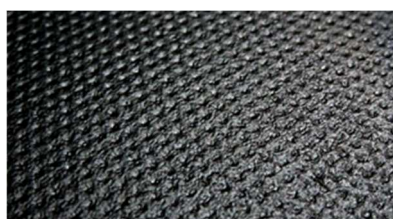
図 20 焼き面に付与した幾何学シボ半球状凹型 (铸造品)
