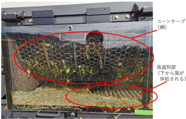
図2 コンバイン内部で雑穀が詰まっている様子
