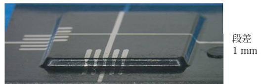
写真3 i-SB法による立体配線の試作
