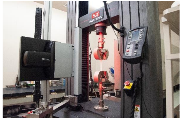
図4 試験装置外観 (Instron社 5982型)
