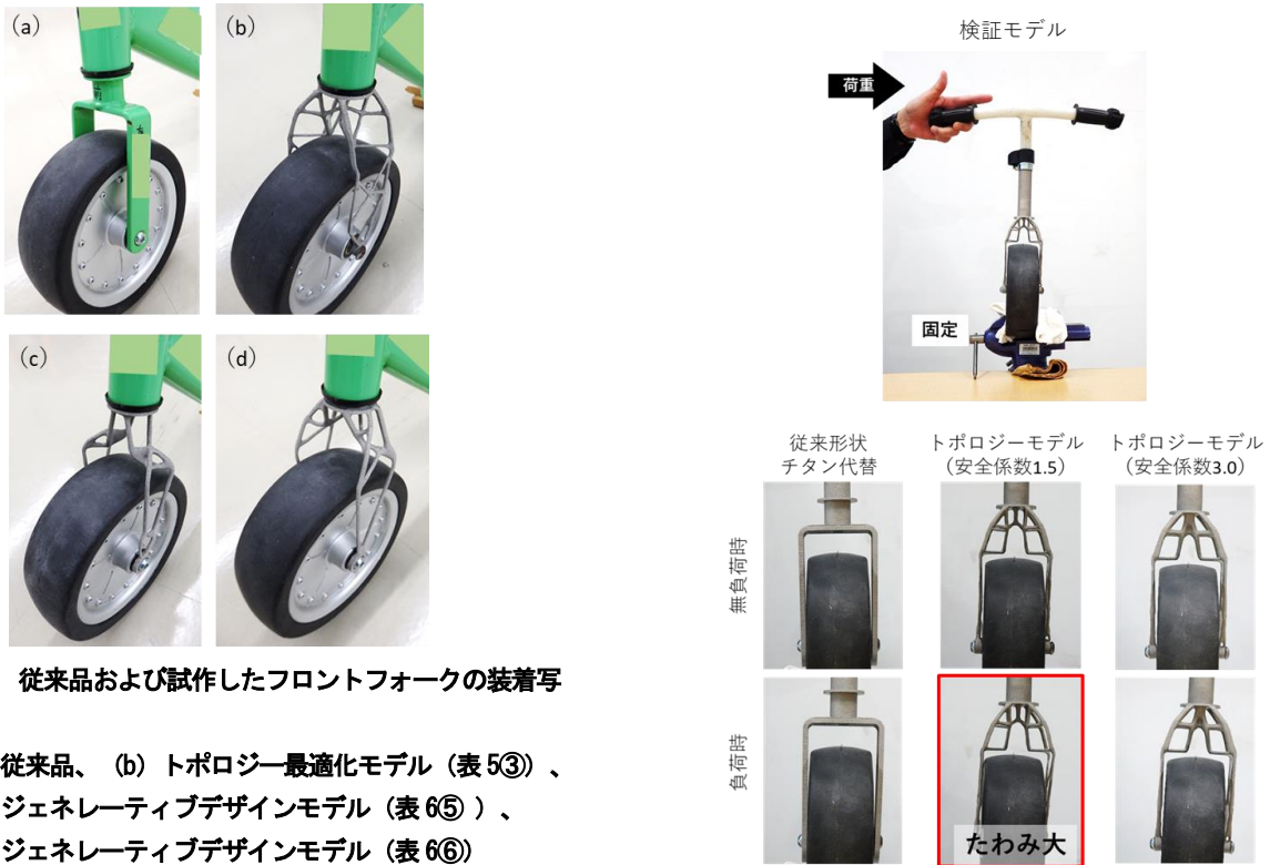
図14 横方向からの荷重負荷検証モデルおよび検証結果
