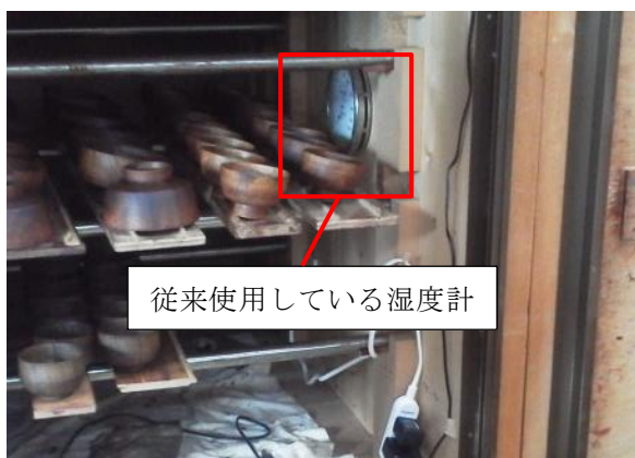
図2 漆風呂内に設置している湿度計
