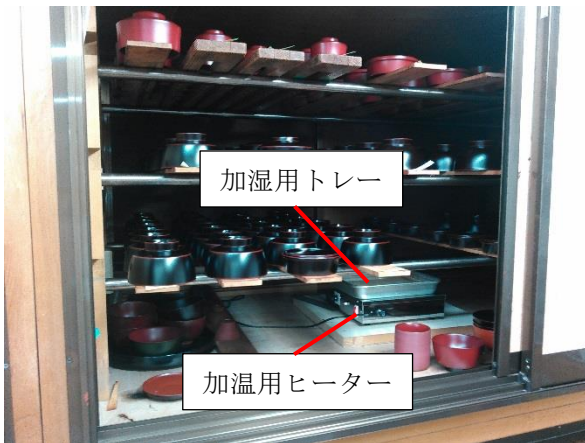
図1 漆風呂と加温用ヒーターおよび加湿用トレー
