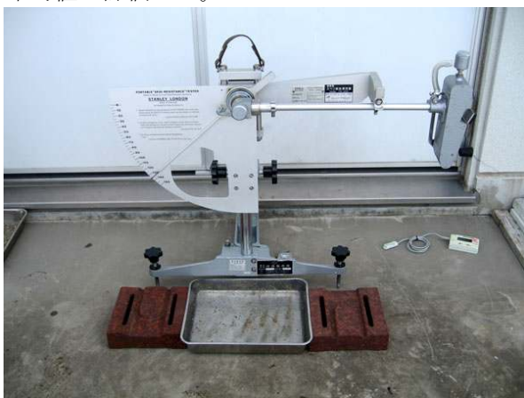
図 3 滑り抵抗試験状況
