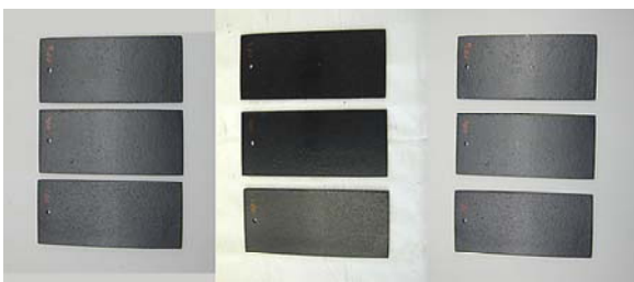
図6 条件7 耐食性試験の結果 (左：試験前、中：4時間後、右：24時間後)
