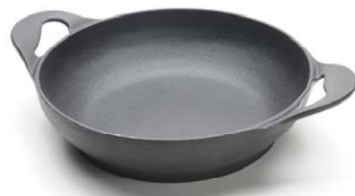
図7 塗装済製品形状試料(完全無機型塗料)
