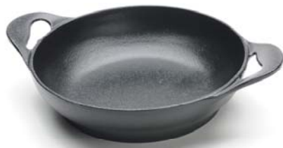
図8 塗装済製品形状試料 (ハイブリッド型塗料)
