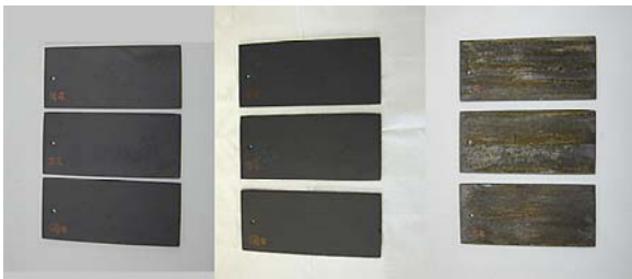
図5 条件6 耐食性試験の結果 (左：試験前、中：4時間後、右：24時間後)
