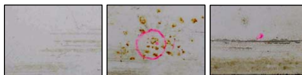
図2 OGの汚れ部、赤錆部、傷部
