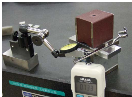
図8 垂直荷重測定の様子
