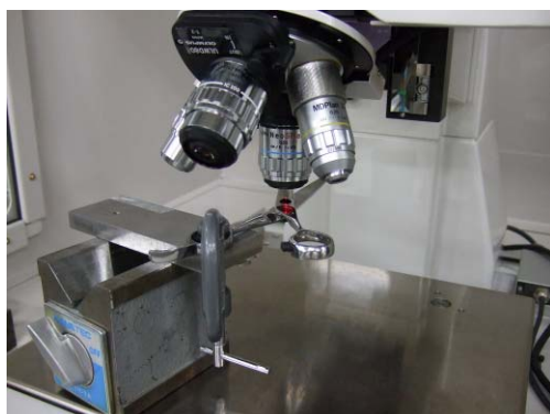
図11 傾き測定の様子
