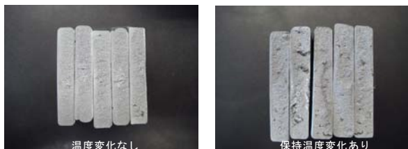
図4 Kモールド破断面
