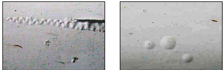
図5 耐溶剤試験における塗膜のしわ・膨れ部
