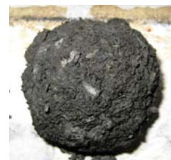
図7 固化状況(配合⑨)
