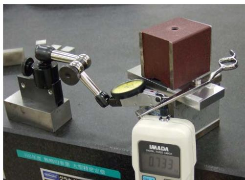
図8 垂直荷重測定の様子
