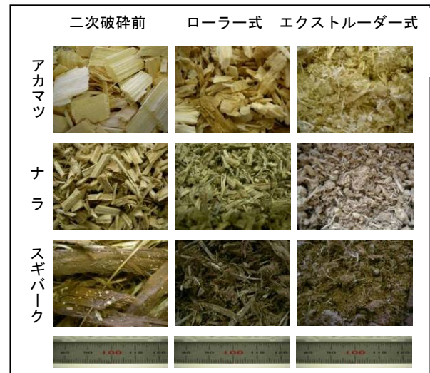
図1 二次破碎方式、樹種ごと外観
