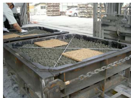
図7 保水性ボード組み込み状況
