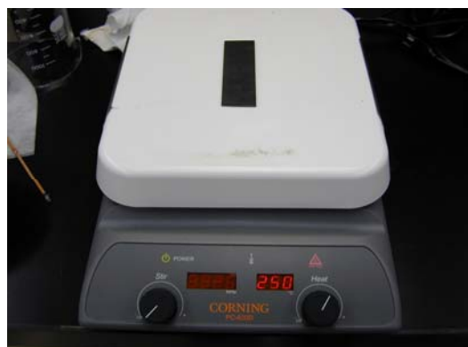
図2 ホットプレートによる焼付塗装
