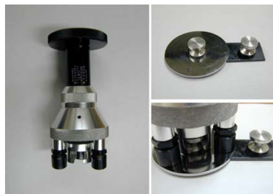
図3 試験機（左）、治具（右上）、剥離試験（右下）
