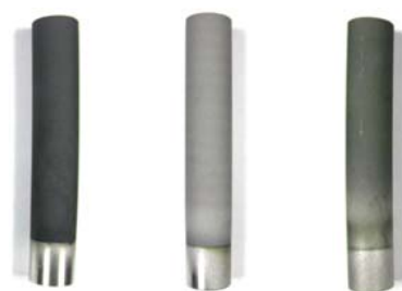
図 4 溶射試料の外観 (左からフレーム、HVOF、プラズマ)
