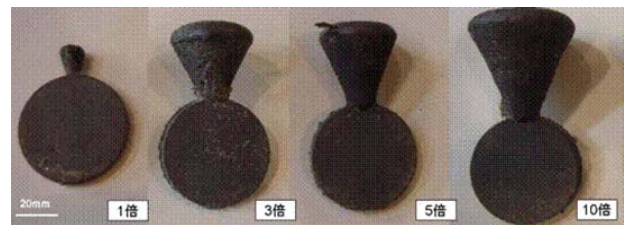
図2 鋳込み後の6mm厚試験片の外観
