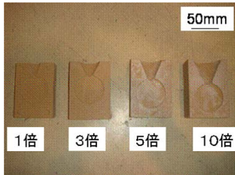
図1 湯口体積を変化させた原型とこれを基に作製した炭酸ガス型
