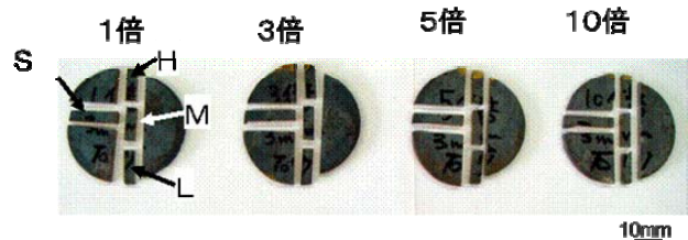
図3 切断した6mm厚試験片
