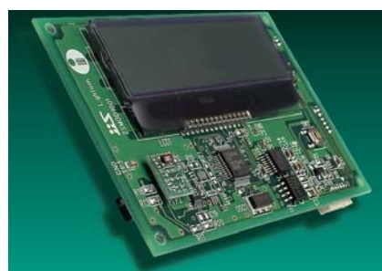
図 1 紫外線センサモジュールの外観図
