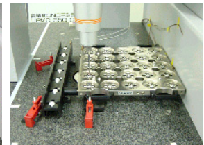
図 12 ボールステップゲージによるスケール校正（Y 軸）
