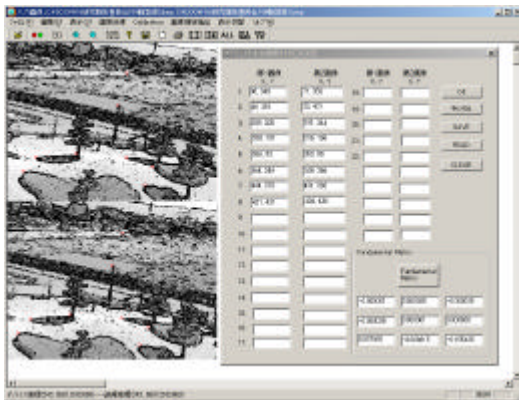
図7 左右画像の対応点入力プログラム
