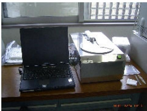
図7 非接触シート抵抗測定装置
