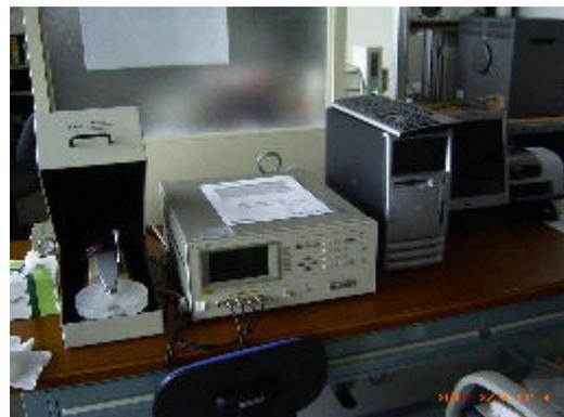
図6 水銀プローブ式キャリア密度測定装置
